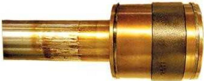
タービン機器の中のバーニッシュは、極めて深刻な影響を及ぼす。制御は不可能であり、よくメンテナンスされた機械でも起こり得ます。しかし適切な監視とバーニッシュ除去の技術があれば、機械故障のリスクは軽減でき、生産の機会損失も抑えることができます。
